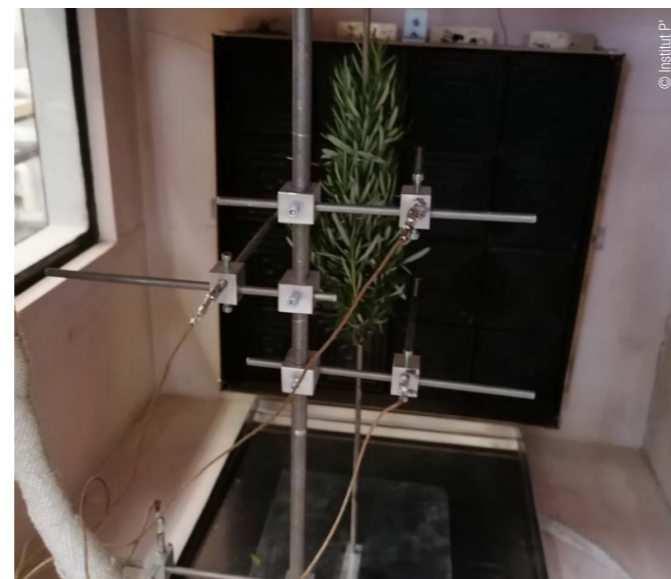
À l'Institut P', les chercheurs soumettent un plant de romarin à une montée en température similaire à celle résultant de l'arrivée d'un feu. Le plant a été muni de capteurs et introduit dans un compartiment équipé d'un panneau radiant.
